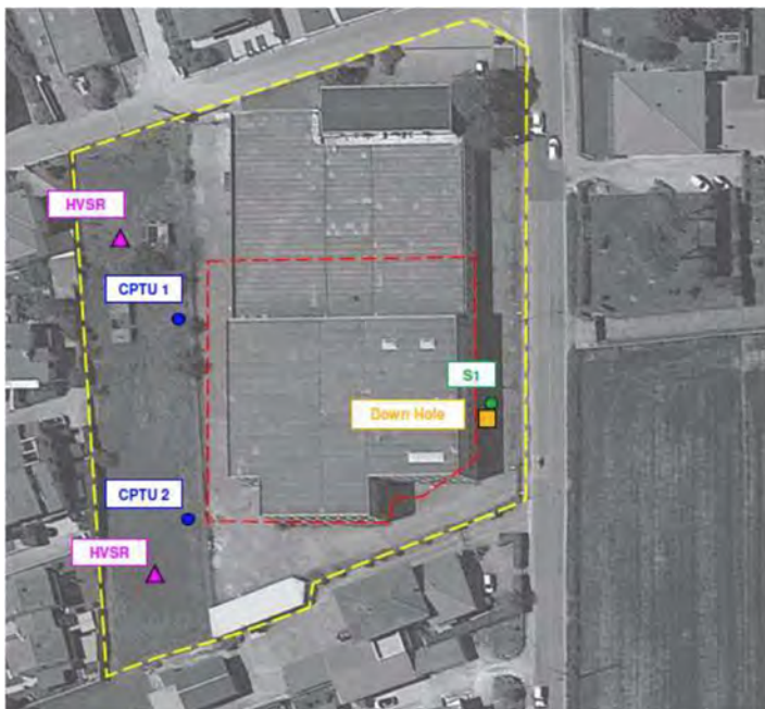
AVOLA 1. Estratto di ortofoto dell'area di intervento, con indicazione del perimetro di proprietà (tratteggio giallo) all'area di sedime del nuovo centro commerciale (tratteggio rosso) unitamente all'ubicazione delle indagini sognostiche eseguite.
